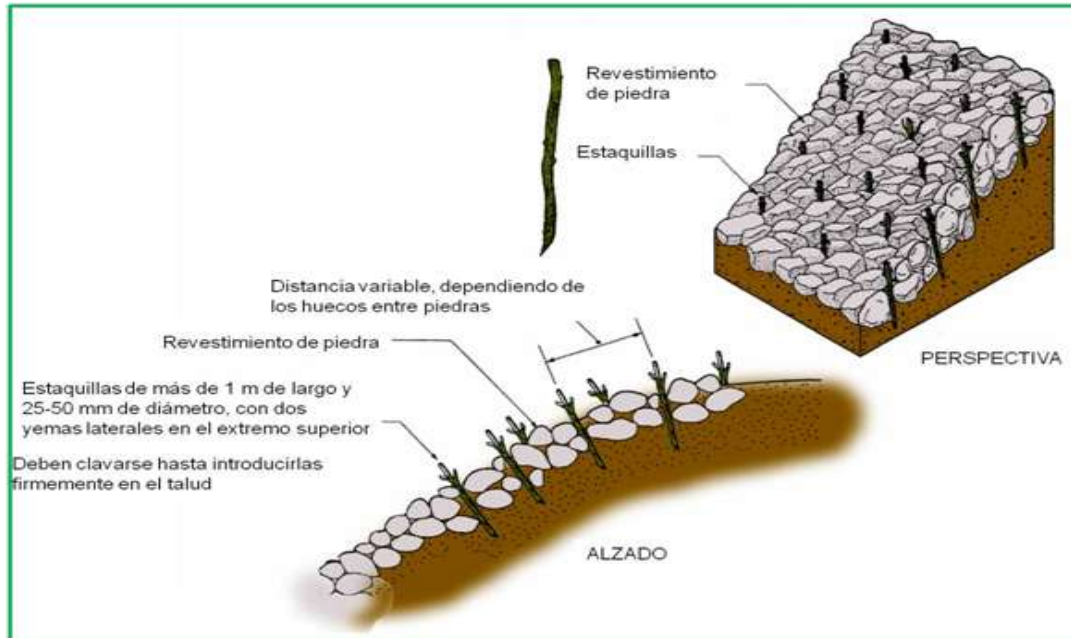
Fig. 45. Esquema de colocación de estaquillas en pedreras.
